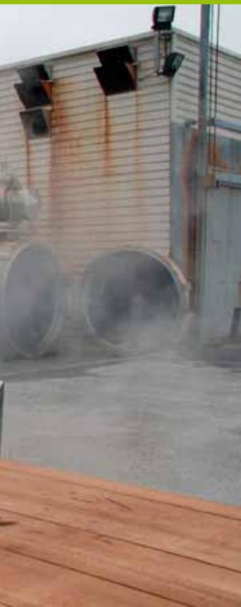
De autoclaaf van Platowood: thermoliseren onder druk en met stoom.
