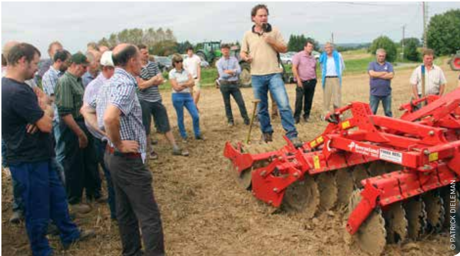
Een schijveneg is een ideale machine om gewasresten te verkleinen en kan dienen als zaaibedbereiding voor grove zaden. Hoe haakser de schijven staan, hoe intensiever de grond bewerkt wordt.
