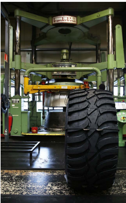
Op de voorgrond een vernieuwde band, op de achtergrond de vulkanisatiepers waar de band net uit komt.
