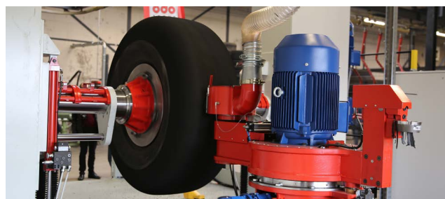
Dankzij deze nieuwe machine gaat het schillen en opruwen van de band sneller en zonder tussenkomst van mensen.
