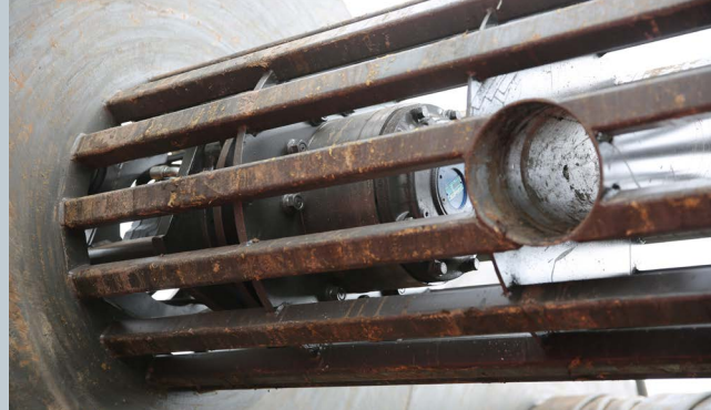
De door Hemos gebouwde haspels worden hydraulisch aangedreven door oude wielmotoren van een Vervaet.
