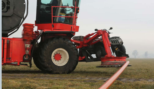
Met het hydraulisch verstelbare wiel kan de slang gemakkelijk worden omgeleid.
