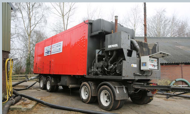
De pompunit annex mestbuffer. Voorop de motor en de hydrauliek, dan een watertank en dan de mesttank.
