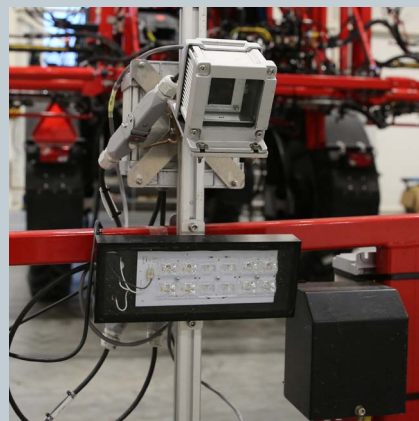
Een testopstelling van het camerasysteem AiCPlus met ledlamp. Het is een zelflerend systeem.
