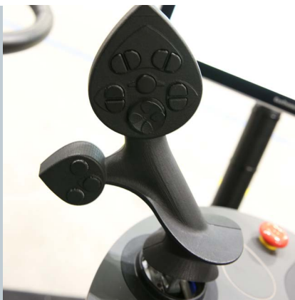
De nieuwe multifunctiehandel schuif je niet meer, maar je beweegt hem nu voor- of achteruit.
