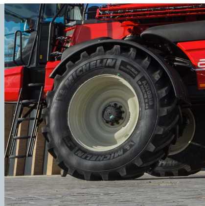
De Michelin AxioBib-banden zijn 230 centimeter hoog en daarmee de grootste banden onder een zelfrijder.
