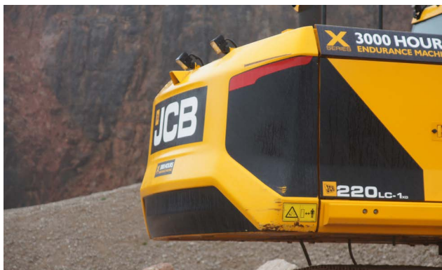
Op deze testmachine is te zien hoe door de uitstekende randen beschadigingen beperkt blijven tot de hoeken.
