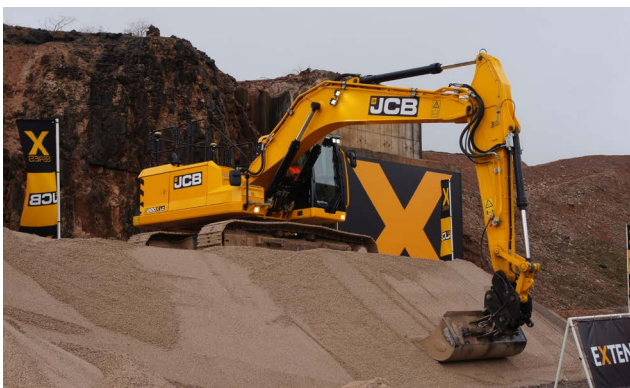
Op wens kan de machine af-fabriek worden geleverd met een voorbereiding voor het Topcon- of Trimble-systeem.
