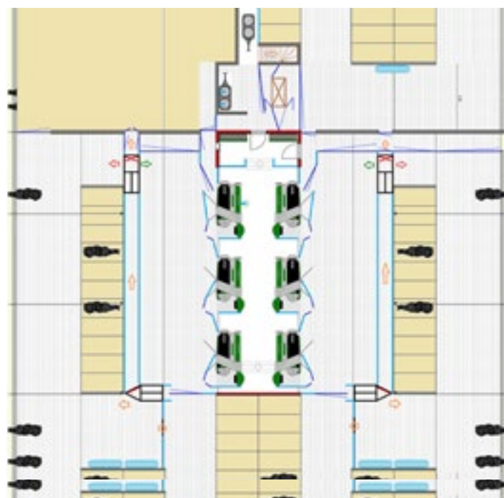
Zes GEA Monoboxen centraal in de stal met slechts één robotruimte. Hier waant je je in een melkput van een open tandem.
