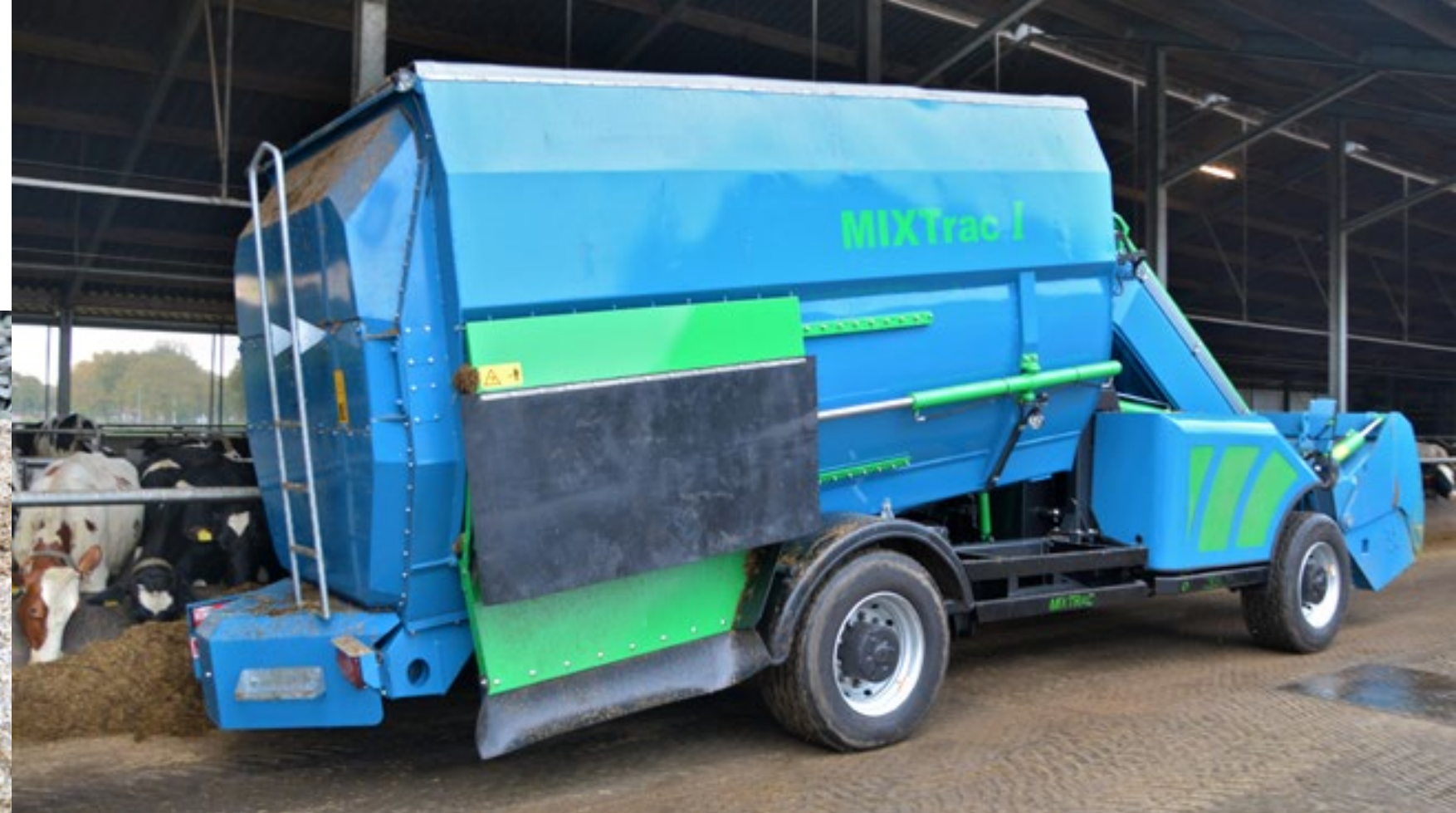
Door de kuip tijdens het mengen voor- en achterover te kantelen, krijg je een homogeen rantsoen. Tijdens het voeren kanel je de kuip achterover. Op deze manier blijft er geen restvoer in de mengkuip achter.
