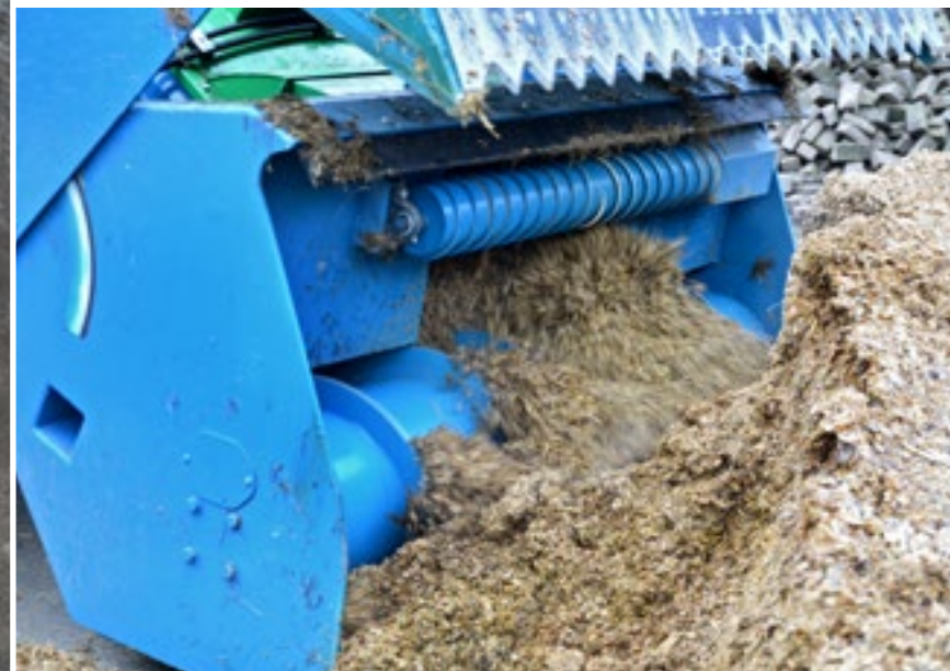
De horizontale vijzel in de kuilhapper brengt het voer naar de transportband, die het voer naar de kuip transporteert.
