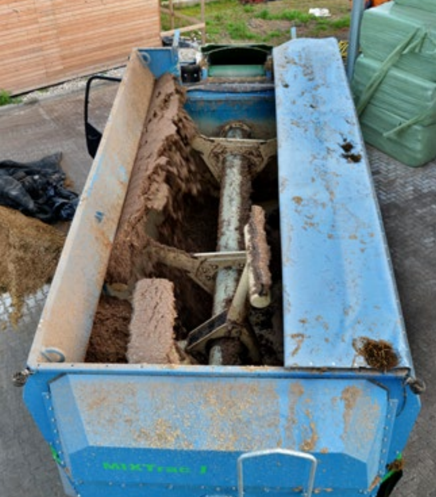
De peddelmenger bestaat uit drie lange en zes korte peddels. Deze korte peddels zorgen voor een gelijkmatige uitdosering.
