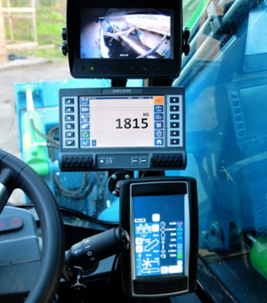
Op het bovenste scherm zie je de camerabeelden, het middelste geeft je inzicht in het geladen rantsoen en via het onderste scherm stel je de machine in.
