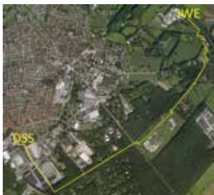
Tussen Industriewater Eerbeek en DS Smith ligt een 3,5 kilometer lange waterleiding
