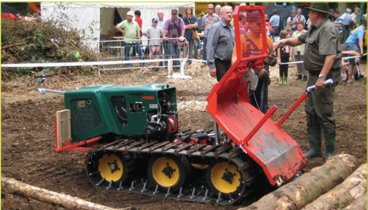
Met zijn 15 PK en 1 ton trekkracht blijft deze Forest Horse MK 13 beter uit de buurt van het serieuze zaaghout, maar voor brandhout is dit speeltje uitermate geschikt!
