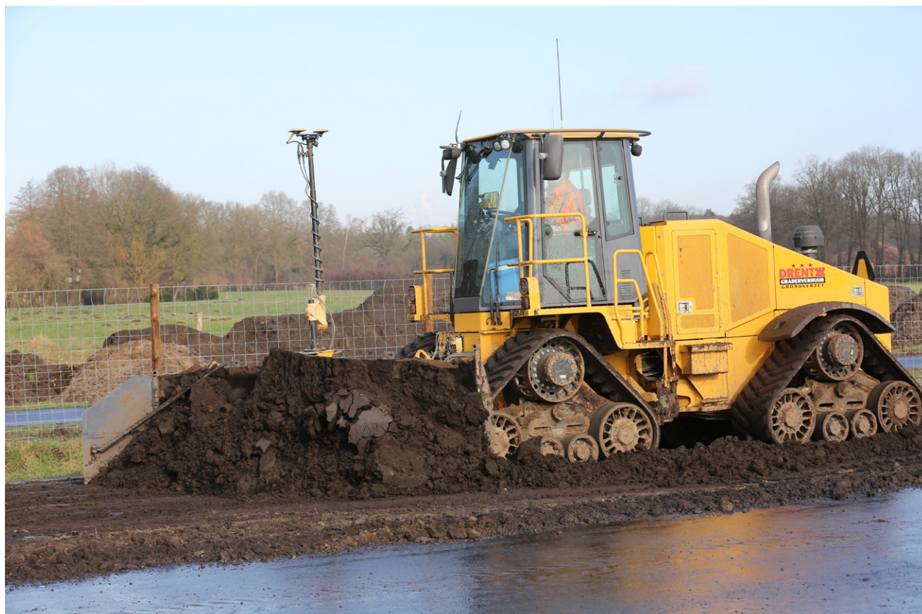
De John Deere High Speed Dozer is in de eerste plaats een dozer, maar hij kan ook het werk van een grader prima aan.
