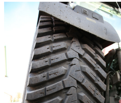
De band heeft veel meer nokken dan een traditionele band en een doorlopende middenring.
