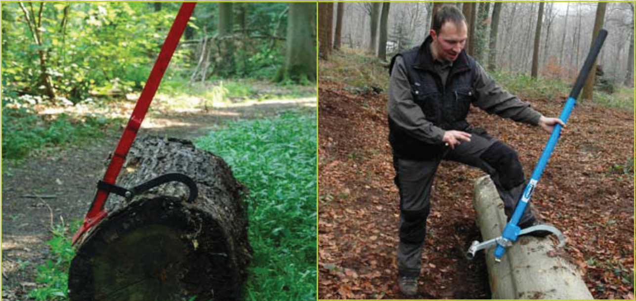
Figuur 3: Gecombineerde velhevels/kantelhaken (links) hebben als voornaamste nadeel dat de kantelhaak zich dikwijls niet goed in het hout vastbijt. Op dat vlak werken enkelvoudige kantelhaken (rechts) stukken beter.
