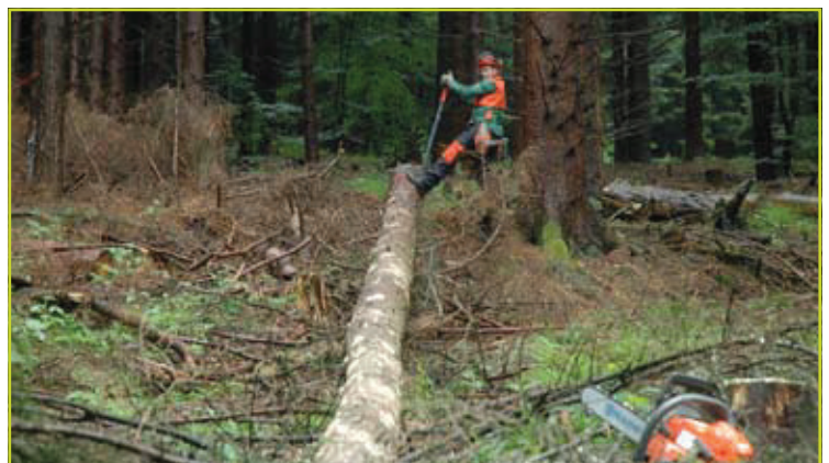
Figuur 2: Boomstammen omdraaien tijdens het onttakken is een klassieke toepassing van de kantelhaak. Hier wordt een halfonttakte fijnspar gedraaid.
