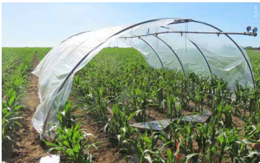
De regenvalsimulator in een proefveld met maïs. Met een spuitboom kan men hevige regen nabootsen. Via schotten in de bodem worden afstromend water en grond opgevangen in een trechter.
