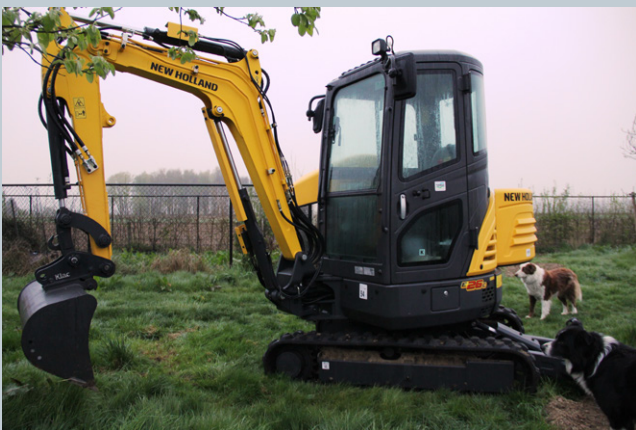
Bij deze modern vormgegeven minigraver blijft het geopende portier binnen de draaicirkel. In dit geval is de machine voor stabielere werken uitgevoerd met extra contragewicht.
