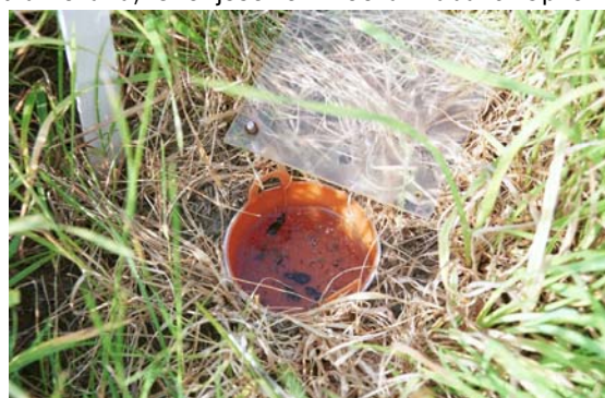
Foto 2.3. Potval zoals gebruikt voor de monitoring van bodemgebonden fauna. De plastic deksel (tegen inregenen) is hier opzij gedraaid om de inhoud te tonen.
