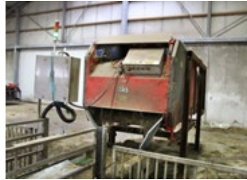
Ruwvoer wordt automatisch gedoseerd uit voercontainers.
