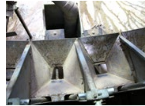
Zelfs de restbrok van de carousel wordt automatisch afgevangen.
