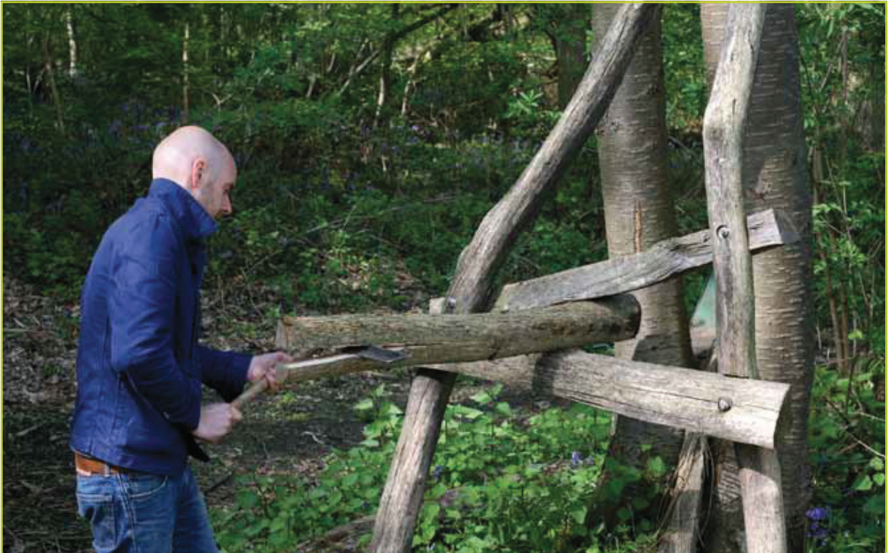
Figuur 3: Klieven van het hout met een kliefmes. © Tom Declerck
