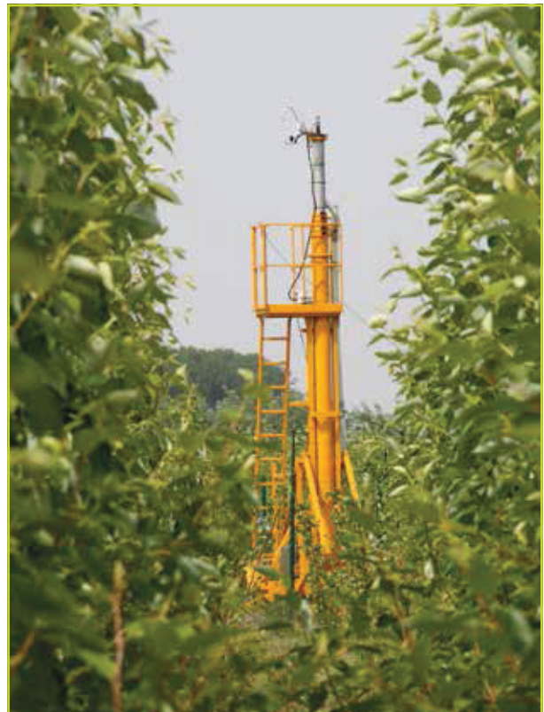
Figuur 4: Meteorologische meetmast in de POPFULL-plantage te Lochristi die de uitwisseling van vijf broeikasgassen (CO 2 , N 2 O, CH 4 , O 3 , H 2 O) monitort.
