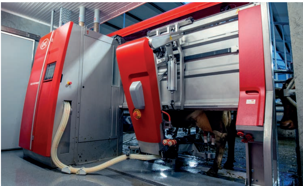
De Lely Astronaut A5 verbruikt dankzij de nieuwe aansluitarm 20 procent minder energie
