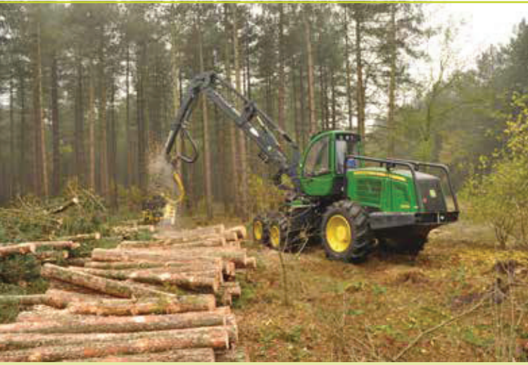
Figuur 3: Een harvester aan het werk in een dennenopstand in Bosland. De stammen worden verzaagd in stukken van 2,5 m voor de spaanderplaatindustrie, terwijl de toppen apart gestapeld worden om ze later te versnipperen voor bio-energie.
