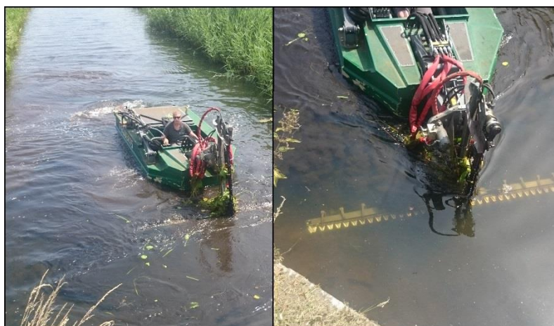
Figuur 3 – Het maaien van de Eefse beek met de maaiboot.
