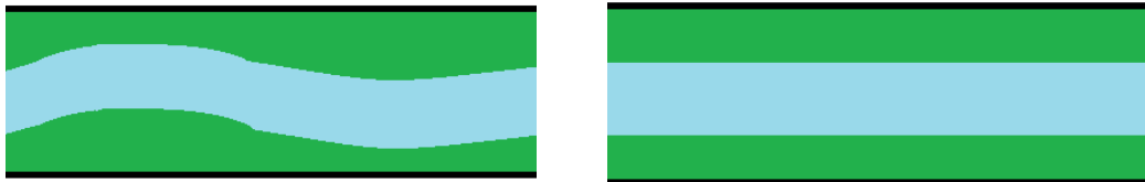
Figuur 3 - Twee varianten van het stroombaanmaaien, bovenaanzicht, links; een "meanderende" maaibaan, rechts; een rechte maaibaan
