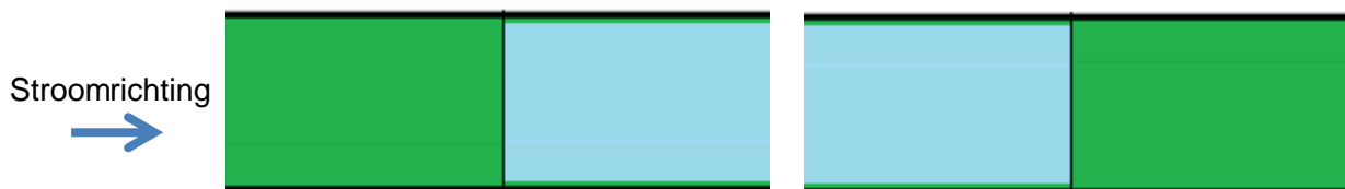
Figuur 7 - Schematisatie van bovenstrooms (rechts) of benedenstrooms (links) maaien
