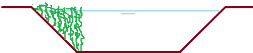
Figuur 6 - Schematisatie van aanwezigheid van vegetatie na stroombaanmaaien in combinatie met één talud maaien
