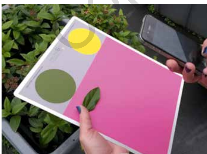
Figuur 5: De Fieldscout Greenindex app is eenvoudig, maar in de sierteelt zijn de bladeren vaak moeilijk te positioneren en zorgt zonlicht voor onnauwkeurigheid
