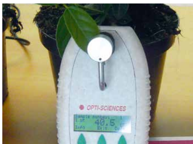
Figuur 6: Een chlorofylmeter (CCM-200) is behoorlijk nauwkeurig, eenvoudig en snel, maar kostelijker
