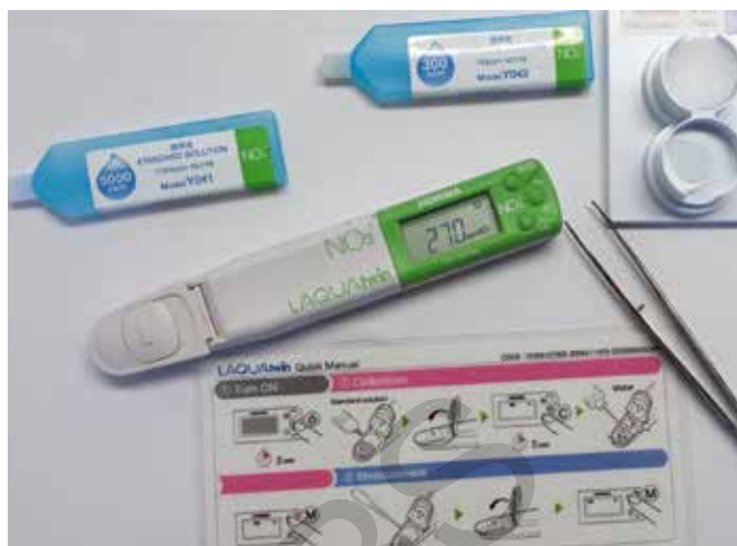
Figuur 2: De Laquatwin nitraatkit is zeer nauwkeurig, maar de procedure is omslachtig
