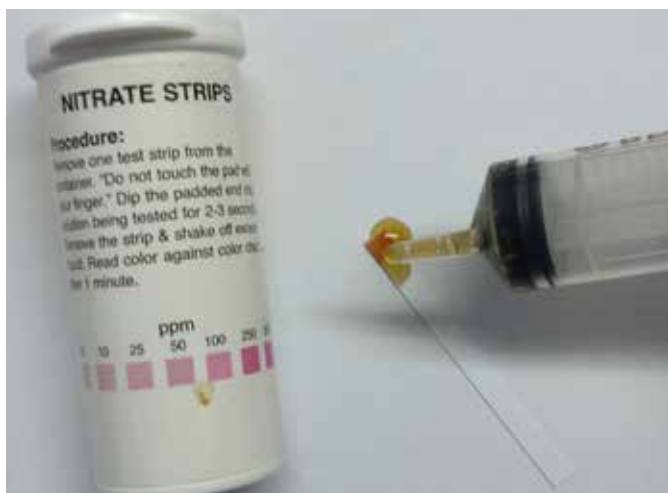
Figuur 1: Nitraatstrips zijn eenvoudig en goedkoop, maar de beoordeling wordt beïnvloed door het bladgroen en is onnauwkeurig
