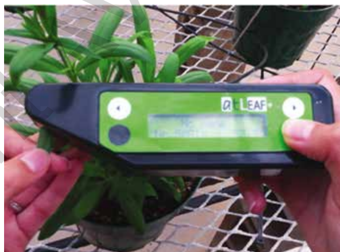
Figuur 4: De atLeaf is eenvoudig, snel, behoorlijk nauwkeurig en betaalbaar, maar wordt beïnvloed door licht (foto: R. Basyouni, 2015)
