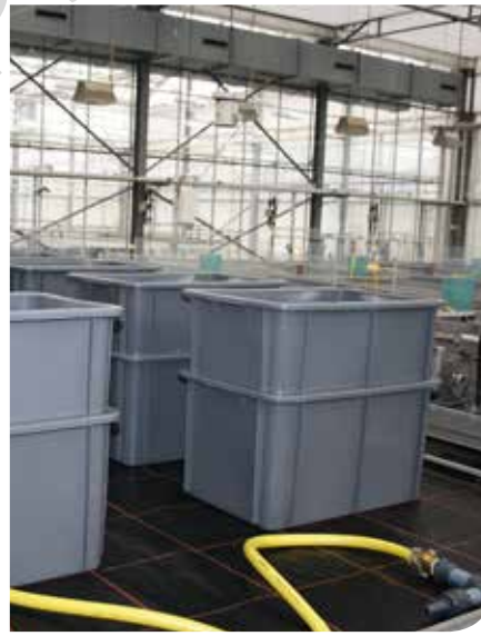
▲ Lysibak-opstelling voor controle doorspoeling van ontsmettingsmiddelen toegepast op vloematten
