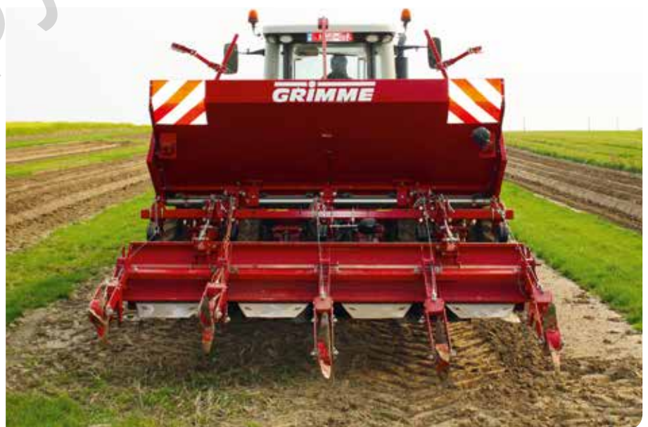
▲ Foto 2: De drempelmachine die in de aardappelteelt gebruikt wordt. Bij het trekken van de ruggen zorgen de schoepjes ervoor dat er putjes tussen de ruggen gevormd worden. Ook bij boomkwekerijteelt is een dergelijk principe mogelijk.
