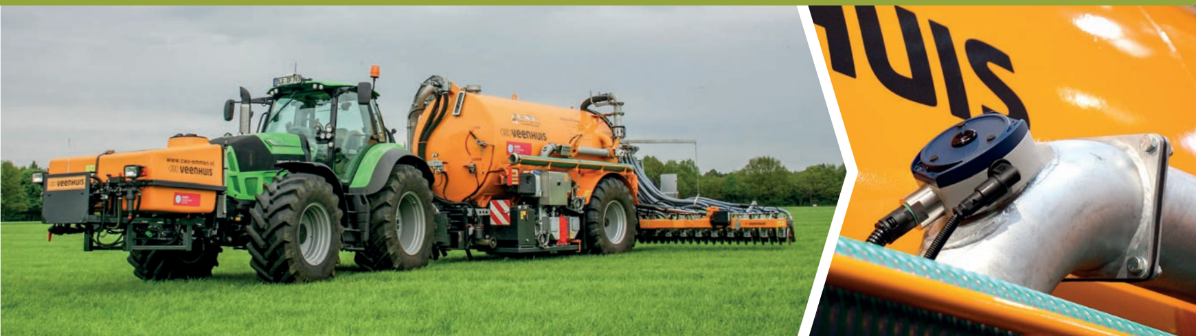
De Veenhuis NutriFlow kan met infraroodmeting (NIRS) bij het emissiearm aanwenden van mest realtime de nutriëntenwaarden vaststellen
