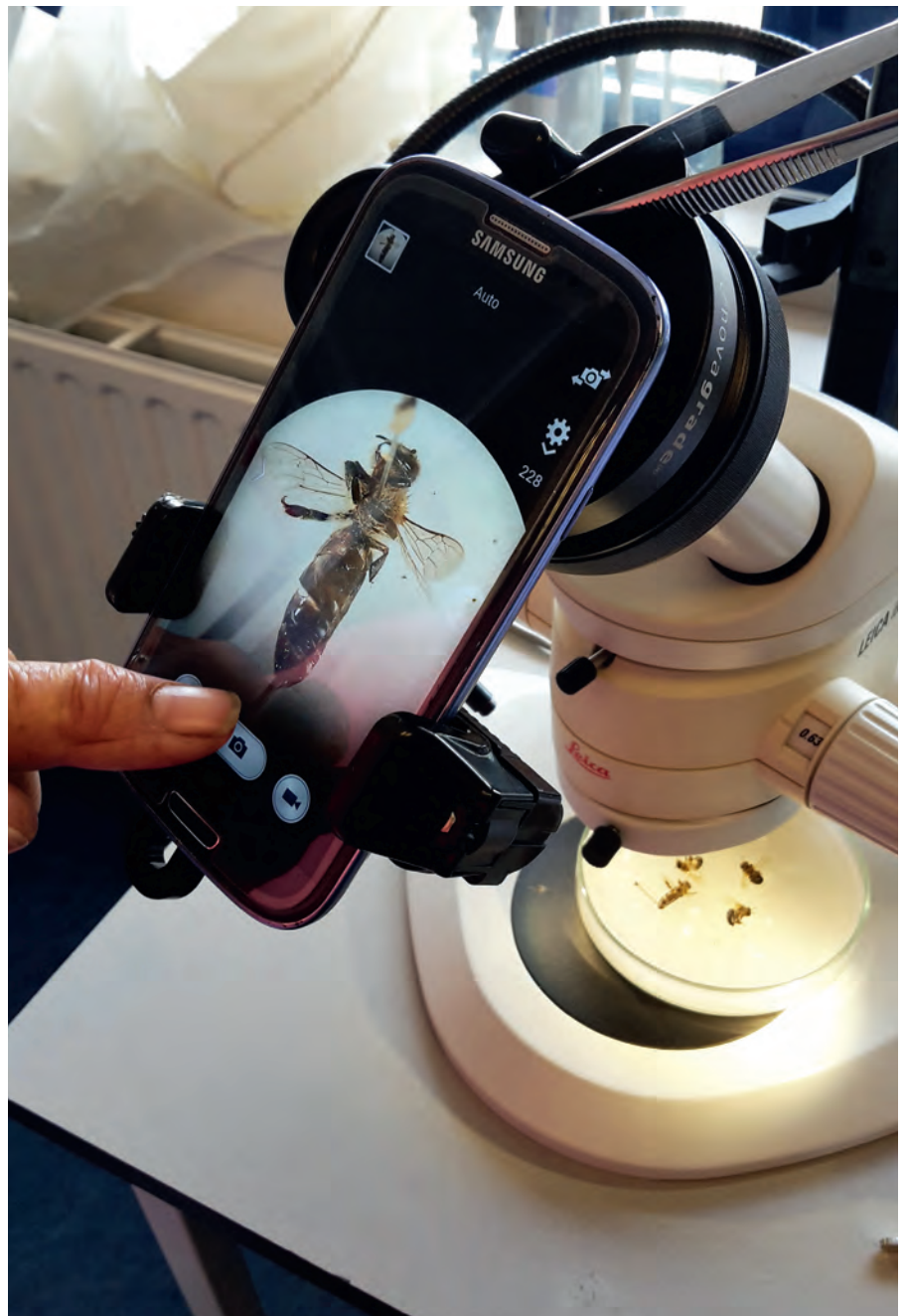
Met behulp van een adapter kunnen met een smartphone foto's gemaakt worden van een geprepareerde bij onder een binoculair.
