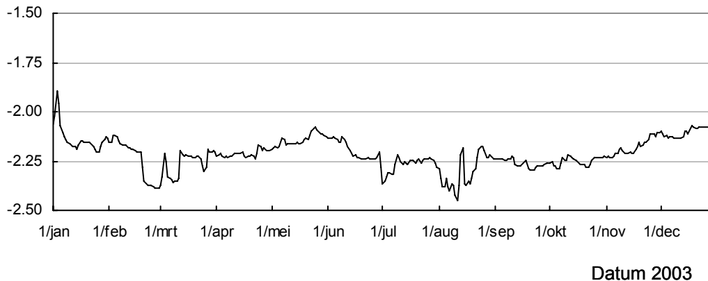
Figuur 3.8 Het verloop van het lage peil (benedenstrooms van stuw) van het Peelkanaal gedurende 2003. Het waterpeil is weergegeven ten opzichte van het maainveld van de proefvelden
