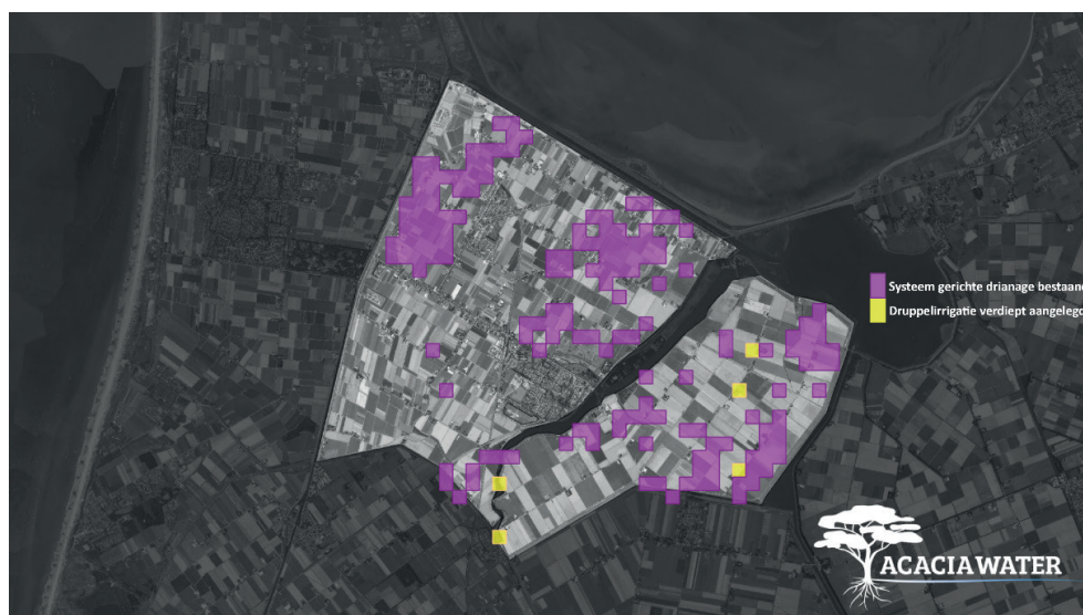
FIGUUR 3.3 KANSRIJKE MAATREGELLEN IN CASESTUDIEGEBIED VOOR HUIDIG KLIMAAT EN EEN IMPLEMENTATIEGRAAD VAN 25%. PAARS: SYSTEEMGERICHTE DRAINAGE, GEEL: ONDERGRONDSE DRUPPELIRRIGATIE
