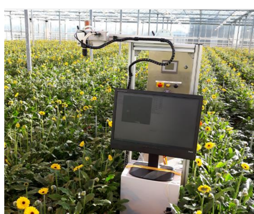
Figuur 3. Meetkar met camera boven het gewas, iedere plant wordt op deze manier in kaart gebracht.
