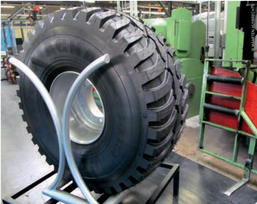
De Magna-landbouwband voor aanhangers heeft een centraal loopvlak en open schouders.
