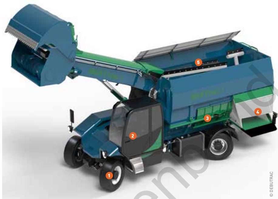
1 4x4-aandrijving en -sturing in combinatie met hondengang moet zorgen voor een erg wendbare machine. 2 De ruime cabine is voorzien van joystickbediening in de armleuning en touchscreen voor het bedienen van de weegkast en machinefuncties. 3 De horizontale schuifdeur van 1,6 meter om de voedergift te regelen. 4 De machine kan (standaard) zowel links als rechts lossen. 5 De grote peddels staan in voor het 'vallend mengen', de kleine peddels optimaliseren het lossen.
