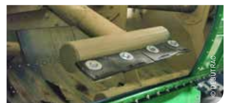
Met de peddels wordt het voer over de messen getrokken.
