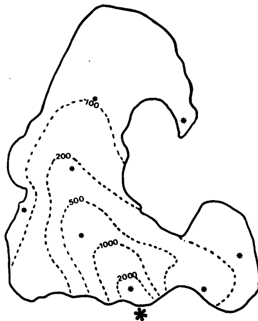
Figuur 5: Verspreiding van opgepompt grondwater in het ven de Keyenhurk, onmiddellijk na afloop van een maand inlaat op 24 april 1996. Weergegeven zijn lijnen met gelijke alkaliniteit ( \mu\text{eq/liter} ) en de monsterpunten. * = Inlaatpunt grondwater
