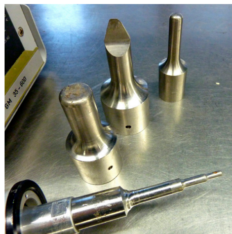
Op de ultrasone apparatuur werden zowel scherpe als stompe koppen getest
