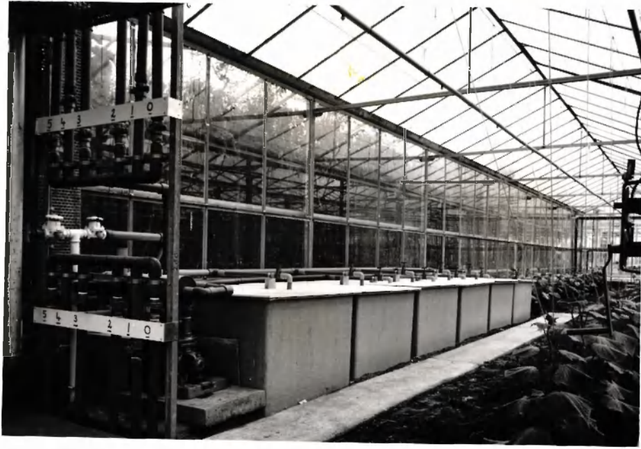
(22746-3) Opstelling van de bakken waarin het water wordt vermengd.
