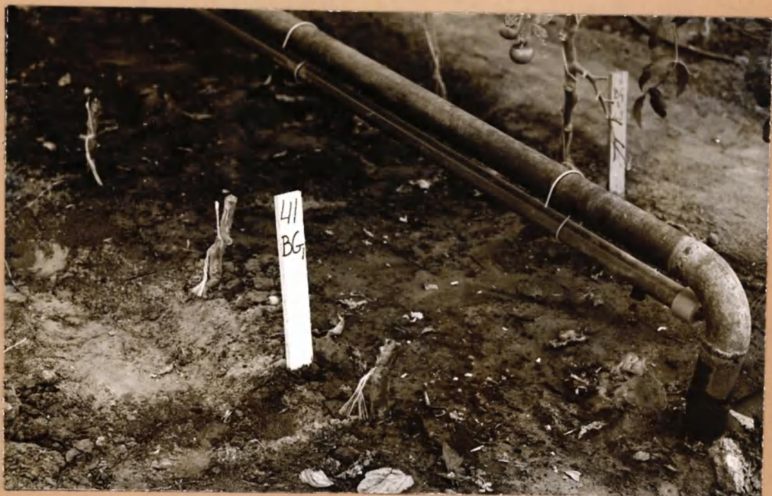
fig.2 Regenleiding met sproeidoppen naar beneden gericht
