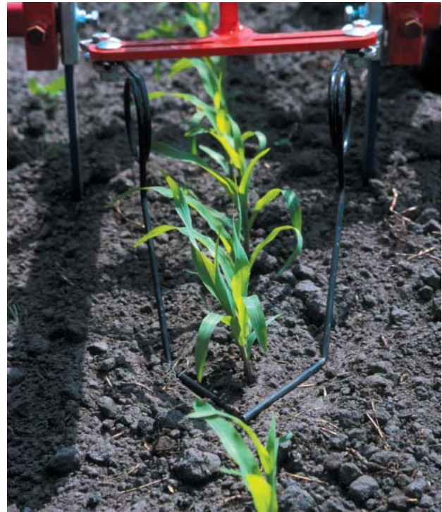
Torsiewieder boven maïs (werkend; dan met de uiteinden 1-2 cm door de grond.
