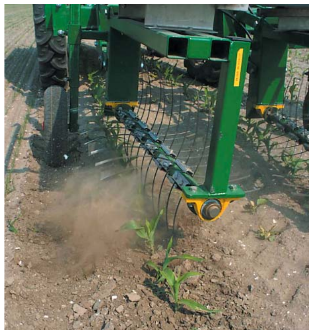
De aangedreven eg in actie in maïs.
