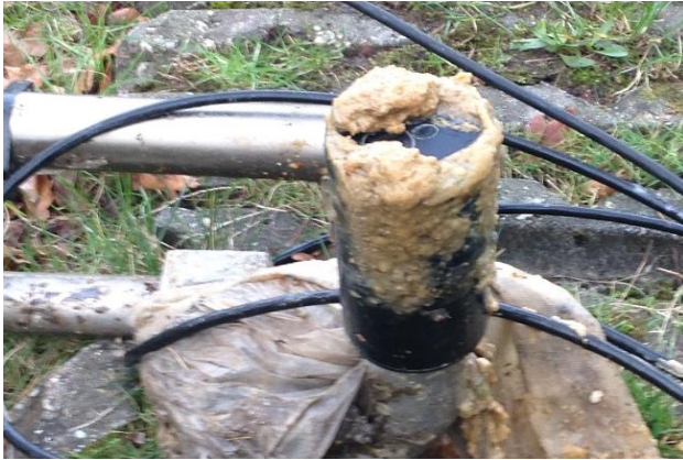
Afbeelding 2. Vervuiling van sensoren, een week na schoonmaak
