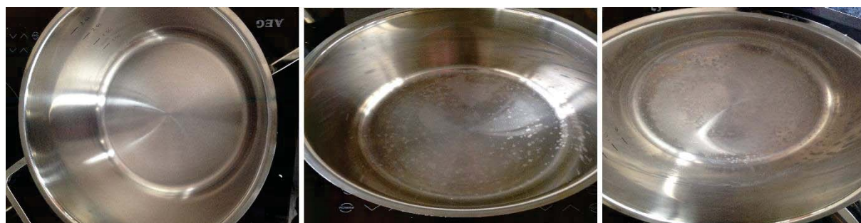
Afbeelding 4. Voorbeeldfoto's van pannen met kalkafzetting (v.l.n.r. geen aanslag, weinig aanslag, veel aanslag)
