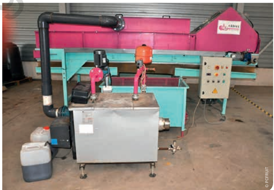
Douchemachine voor de warmwaterbehandeling van fruit.
