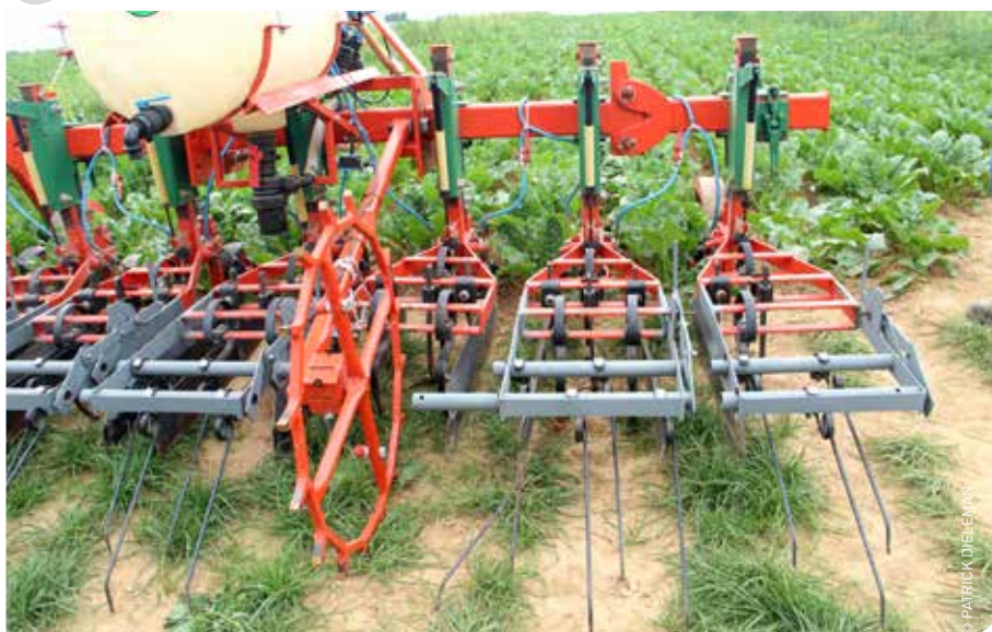
Deze dés herbineuse schoffelt tussen de rijen en spuit alleen de rij.
