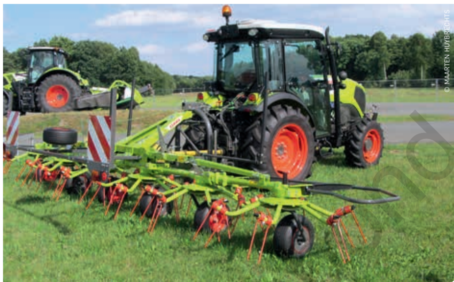
Het Maxi Spread-principe van Claas wordt nu ook bij de kleinere Volto-schudders ingevoerd. Claas stelt dat er beter en sneller kan gewerkt worden met deze tandmontage.
