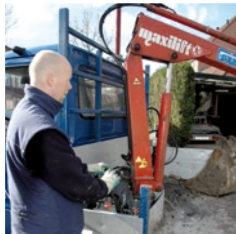
Voor een zware laadkraan is elektrische bediening handig. Is er geen elektrische voorziening aanwezig, dan is een accu die zich automatisch oplaadt aan te raden.
