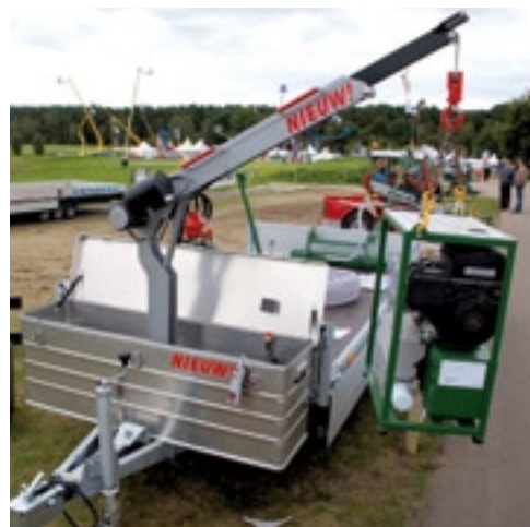
De LK 400 laadkraan tilt maximaal 400 kg met een elektrisch aangedreven lier. De laadarm kan Rein Drost leveren in een aluminium kist.
