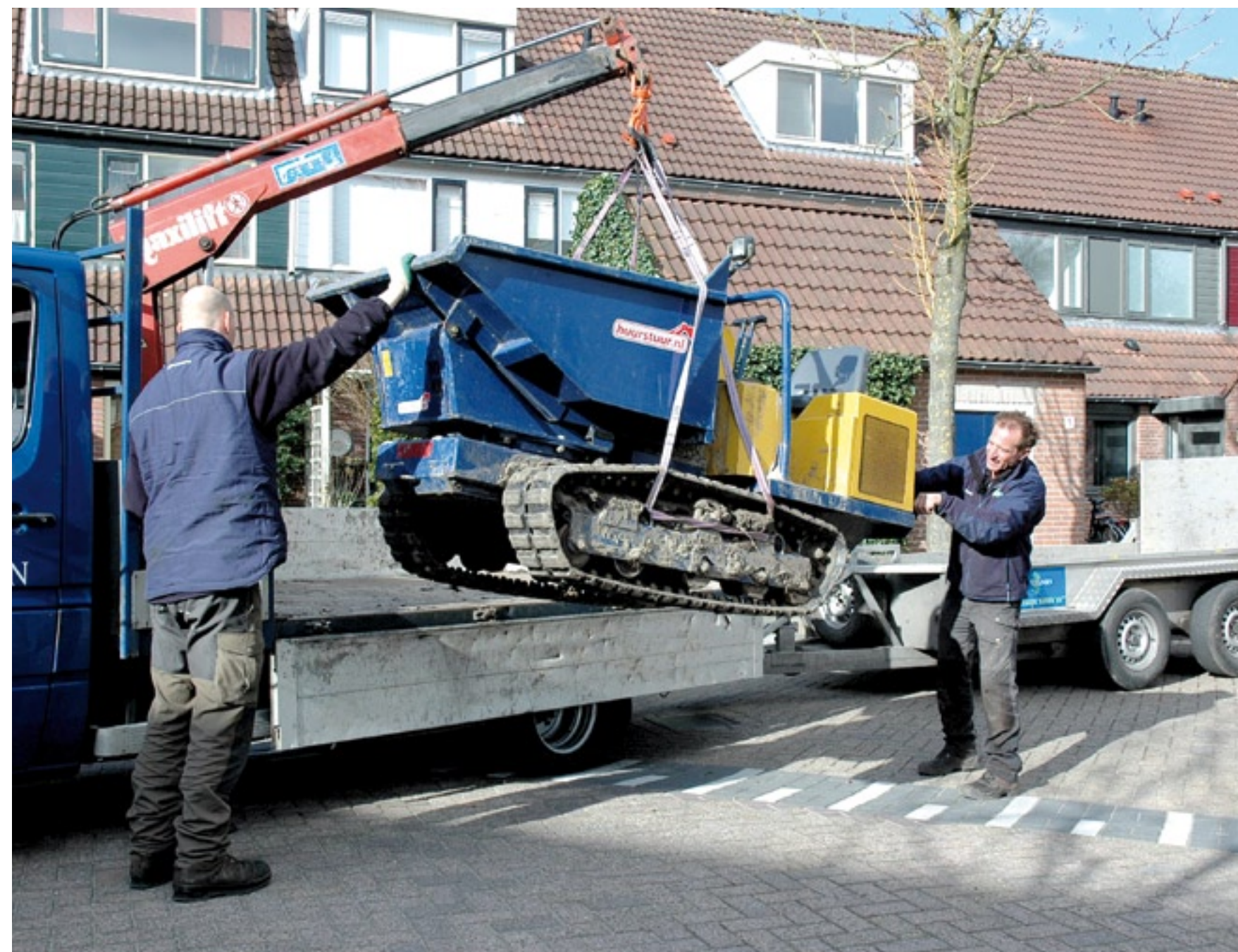
Een laadkraan neemt een heleboel handwerk uit handen. Laadkranen met een heflast vanaf 500 kg per meter moeten jaarlijks worden gekeurd.
