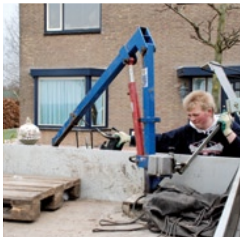
Voor een paar honderd euro heb je al een eenvoudige laadarm die je met bouten op de bak van de aanhanger kunt schroeven. Deze bedien je met een potkrik hydraulisch.
