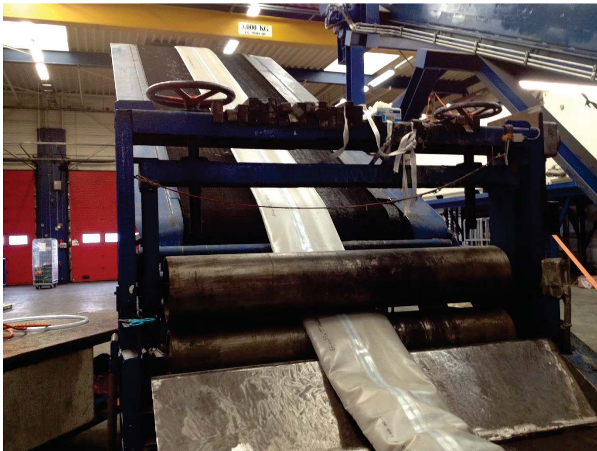
Afbeelding 2. Impregneren van kous met hars in een fabriek. De hars wordt aangebracht in de kous waarna de hars door middel van walsen in de juiste hoeveelheid wordt verdeeld
