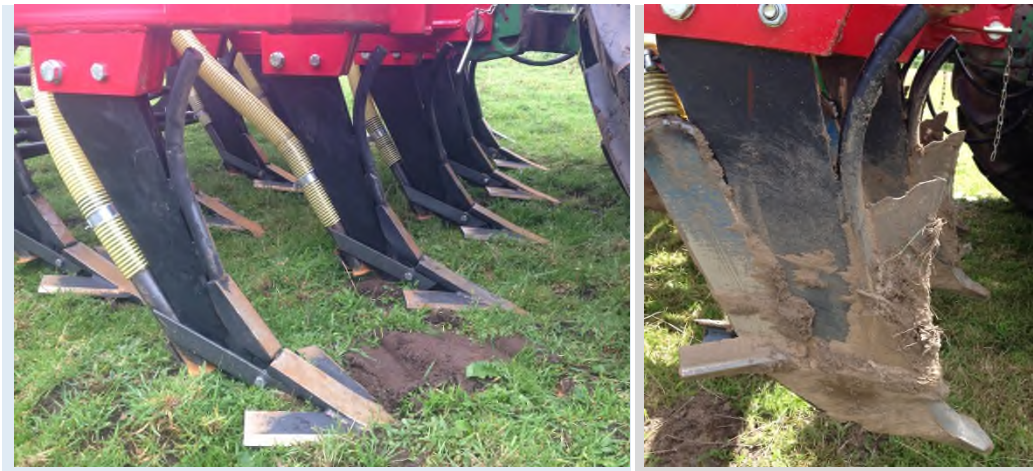
FIGUUR 9-1 . REGULIERE GANZENVOET (LINKS) EN BEITEL MET EXTRA SNIJVLAK (RECHTS) VOOR HET DOORSNIJDEN EN OPTILLEN VAN DE ZODE. HET DRINKWATERSLIB WORDT VIA DE SLANGEN ACHTER DE GANZENVOET OF BEITEL ONDER DE ZODE INGEBRACHT.
