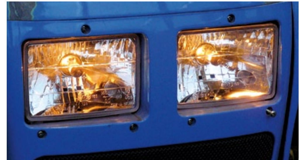
Als de lampen zo zwak branden als op deze foto, dan is de spanning zeker erg laag. De accu kan bijvoorbeeld leeg zijn of versleten.
