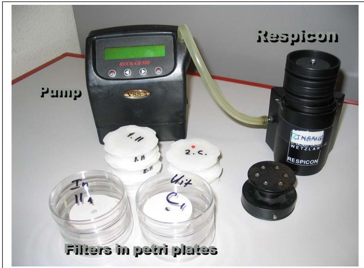
Figuur 5.9 Foto van de Respicon stofmeter en de luchtpomp gebruikt in het onderzoek aan de experimentele luchtwater op 't Spelderholt.
