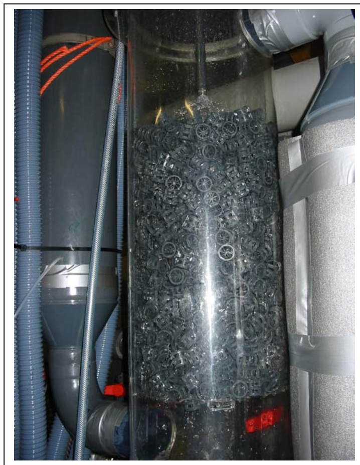
Figuur 5.2 De luchtwasser die in het onderzoek gebruikt werd voor het wassen van de lucht uit de isolatoren.
