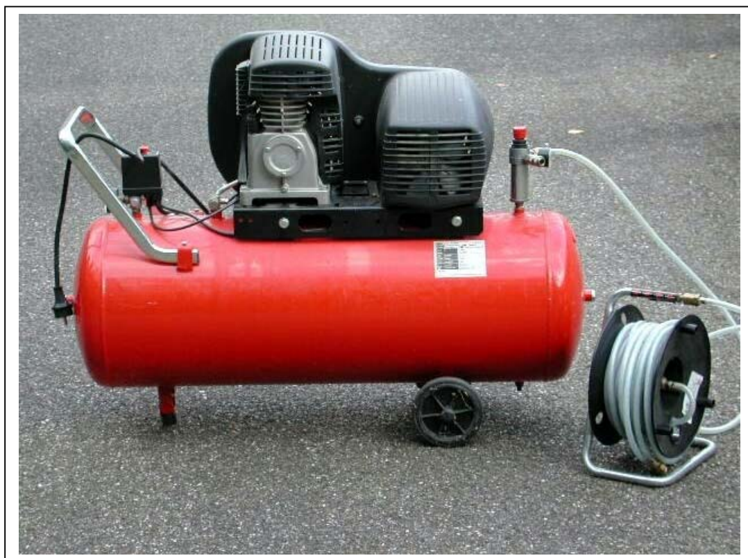
Figuur 5.5 Mecha Concorde compressor waarmee de aërosolen werden opgewekt.
