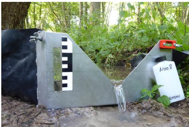
Figuur 5.16: Mobiele meetschot voor debietmetingen in bronbeken
