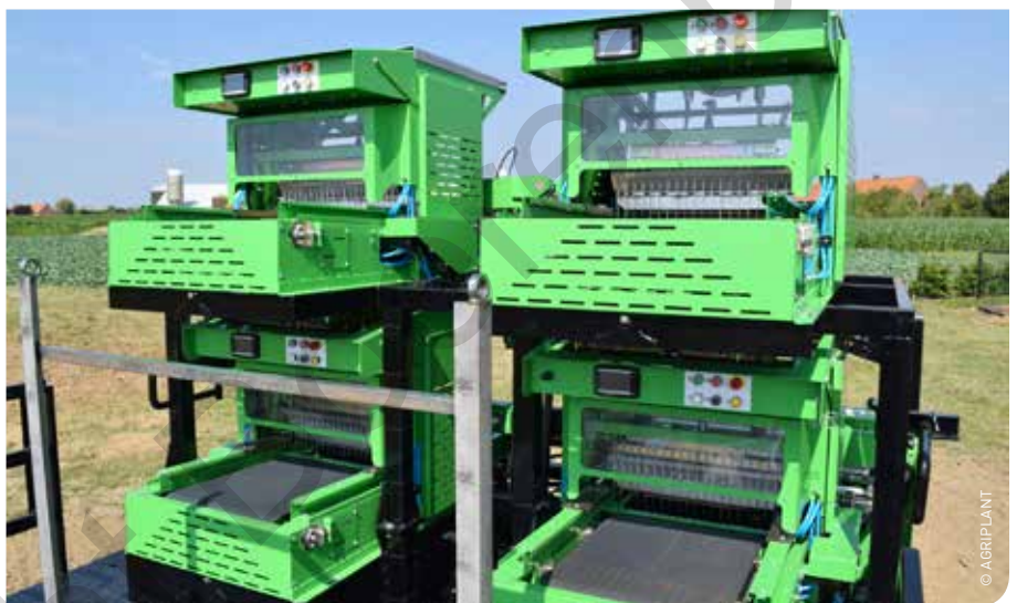
De vier robots werden twee per twee boven elkaar gezet. Elke robot heeft een capaciteit van vier plantjes per seconde.
